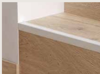
PROFILÉ D'ESCALIER À ENCLIQUETER ARGENT 2500 x 50 x 25 mm. Convient aux revêtements de sol d'une épaisseur de 7 à 15 mm. Aluminium.
